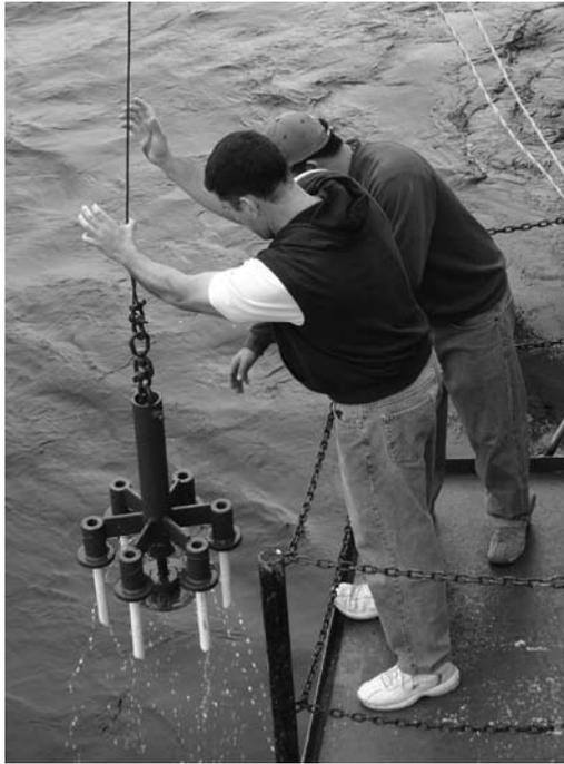
Figura 3. Nucleador de caja tipo Reineck de 102 litros de capacidad utilizado para muestrear los sedimentos durante las campañas oceanográficas del proyecto TALUD.
