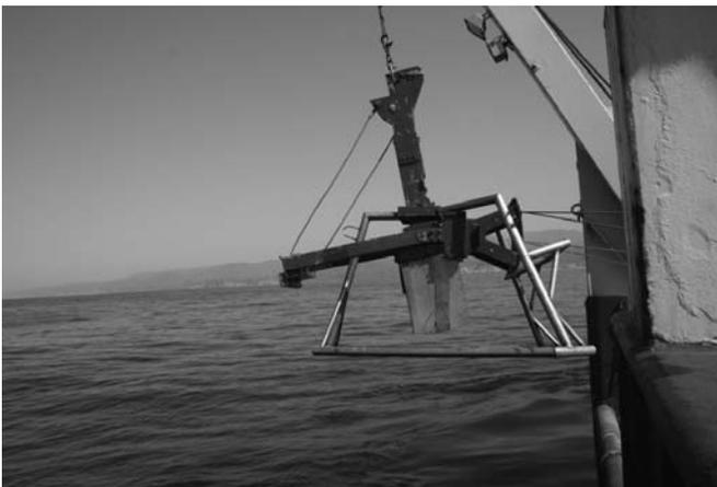
Figura 4. Draga tipo Karling modificada con capacidad de 80 litros utilizada para el muestreo de los sedimentos durante las campañas oceanográficas del proyecto TALUD.
