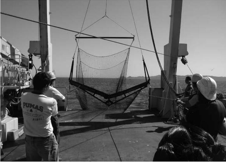
Figura 6. Red de media agua para micronecton recuperada después de un lance con apertura de malla de 1 mm y boca de 1 m<sup>2</sup> utilizada durante las campañas oceanográficas TALUD.
